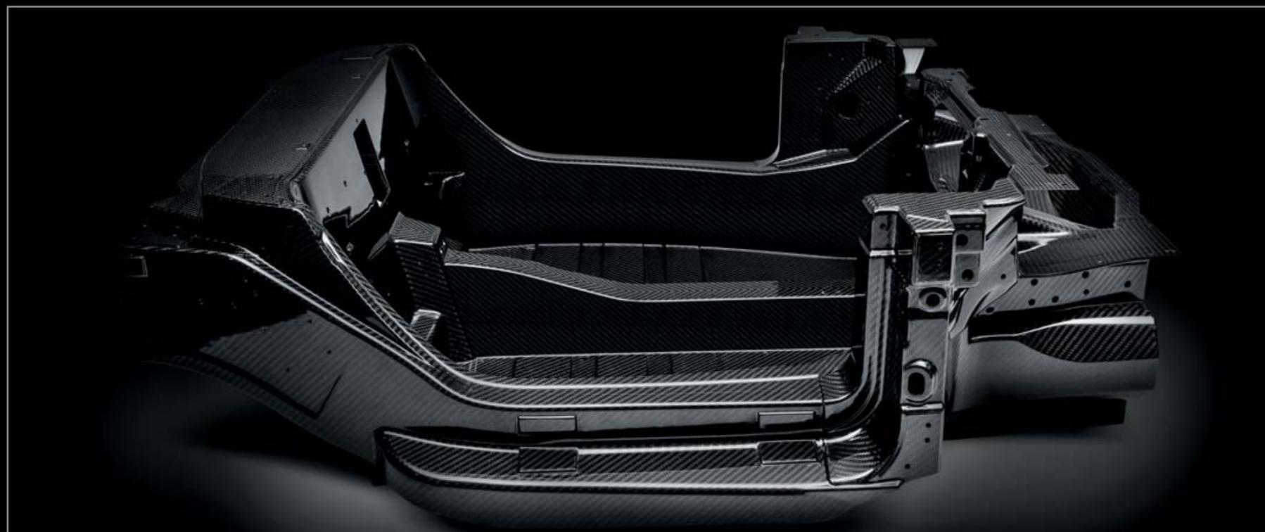
Châssis monocoque en fibre de carbone
