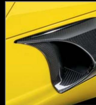
Prise d'air latérale en fibre de carbone
